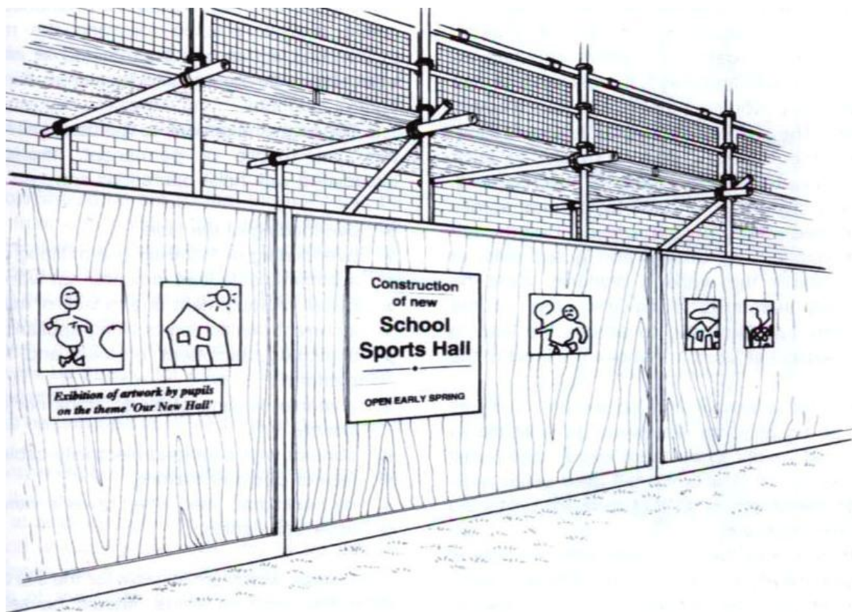
شکل ۸،۱۰ داربست ضد نخاله. پانل ها در اطراف پایه داربست پابت اند تا از بالارفتن کودکان جلوگیری کند.
